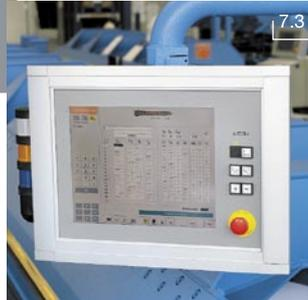
**7.3 CNC5000-Touchscreen-Steuerung** mit 17" TFT-Farbdisplay. Die Steuerung arbeitet mit einem Pentiumprozessor auf Windows-Basis mit automatischem Hinteranschlag und der Möglichkeit, einen konischen Hinteranschlag zu steuern. Im Lieferumfang enthalten ist ein CAD-Zeichnungsprogramm (genauere Informationen entnehmen Sie bitte unserem Detailprospekt).
