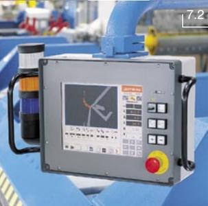
**7.2 CNC500 Touchscreen-Steuerung** mit Farbdisplay, automatischem Hinteranschlag und Grafiksoftware (genauere Informationen entnehmen Sie bitte unserem Detailprospekt).
